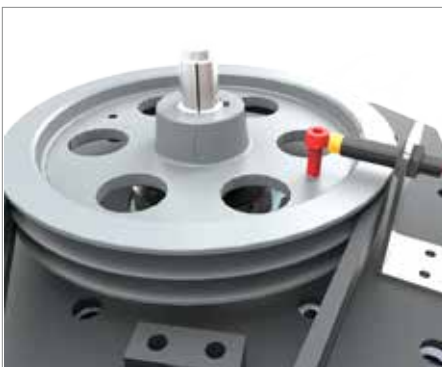
ELECTRONIC CONTROL FOR ALIGNMENT CONTROLLO ELETTRONICO DEI MOTORI AD OGNI GIRO DELLA PULEGGIA
