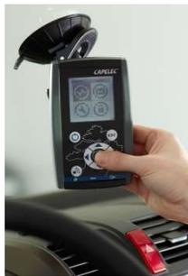
*Opción: módulo inalámbrico dual decelerómetro y podómetro*
