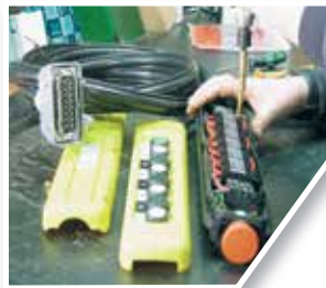
Cableado de botonera Pendant control wiring
