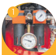
1 Tratamiento de aire
