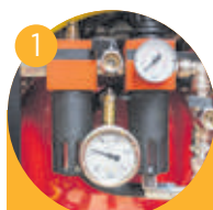
1 Tratamiento de aire
