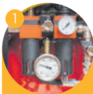
1 Tratamiento de aire
