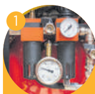
1 Tratamiento de aire
