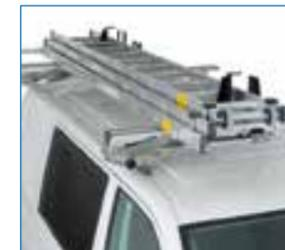
Adecuado para escaleras de 1, 2 y 3 tramos; longitud de escalera máxima hasta 1,5 veces la longitud de la distancia entre travesaños del sistema TopSystem; la distancia entre travesaños puede variar entre 1380 y 3000 mm
