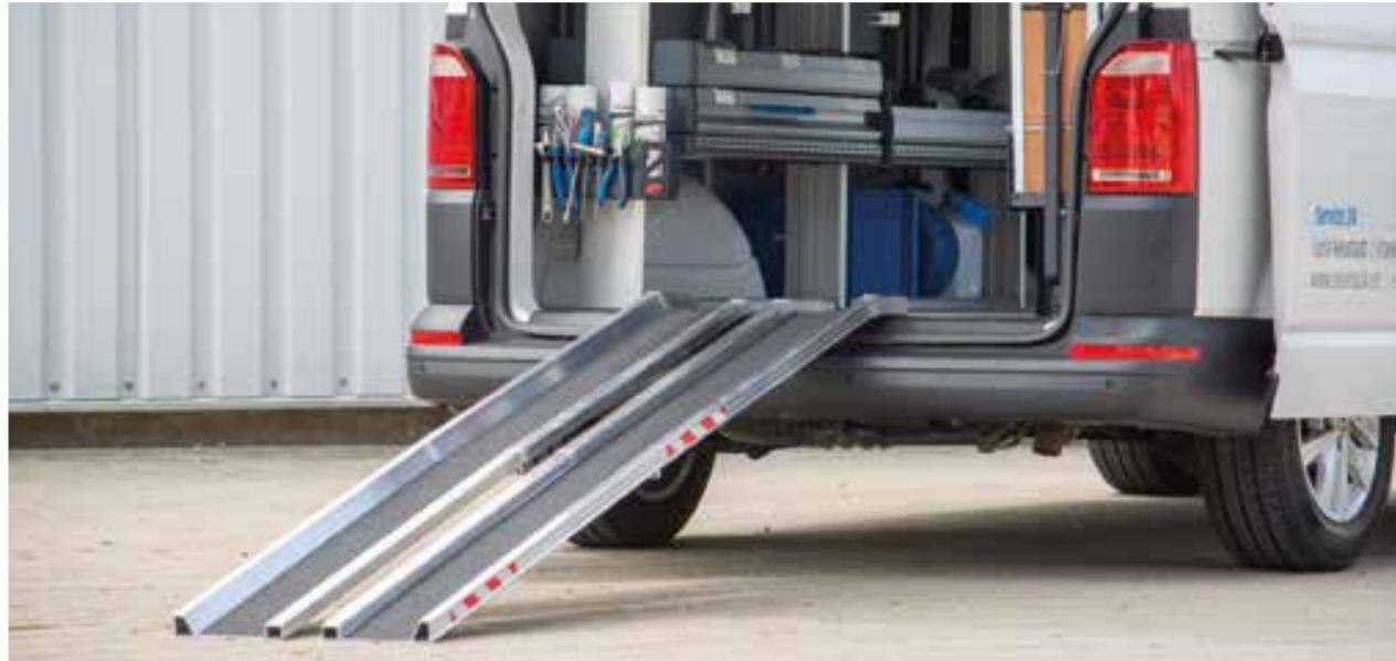
Con las rampas, que están disponibles en dos longitudes, rígidas o plegables, las cargas pesadas y voluminosas se pueden guardar de forma rápida y cómoda. El borde protector lateral (30/42 mm) permite mantener la carga en el carril. El carril tiene una anchura de 150 mm (anchura exterior 234 mm), un revestimiento antideslizante P13 y una capacidad de carga de 380 daN. De esta manera, las rampas protegen la espalda y permiten un proceso rápido y cómodo al cargar y descargar.
