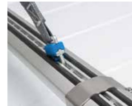
Sujeción sencilla de la carga mediante el sistema de fijación ProSafe opcional integrado.
