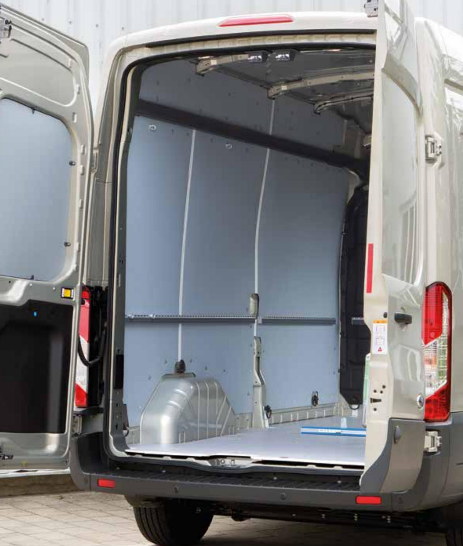
El revestimiento SowaFlex protege el espacio de carga del vehículo. Construido con un material ligero con forma de panel, pesa un 60 % menos que los revestimientos de madera equiparables. Extremadamente resistente a los golpes y arañazos, el material protege la carrocería de daños y puede montarse fácilmente fijándolo a los puntos previstos por el fabricante del vehículo.
