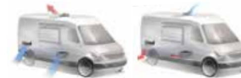
Para el transporte de botellas de gas, la legislación exige una ventilación del vehículo con aberturas libres. Sortimo ofrece un sistema de ventilación que puede ser utilizado para ventilar o airear, según el uso de gases pesados o ligeros. Gracias a su diseño aerodinámico, el caudal de aire nuevo está muy por encima de los requisitos legales.
