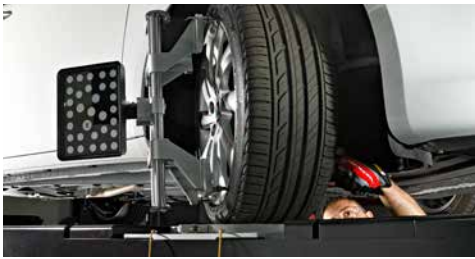
EZ-TOE para un ajuste completo mientras se ajusta la convergencia delantera
