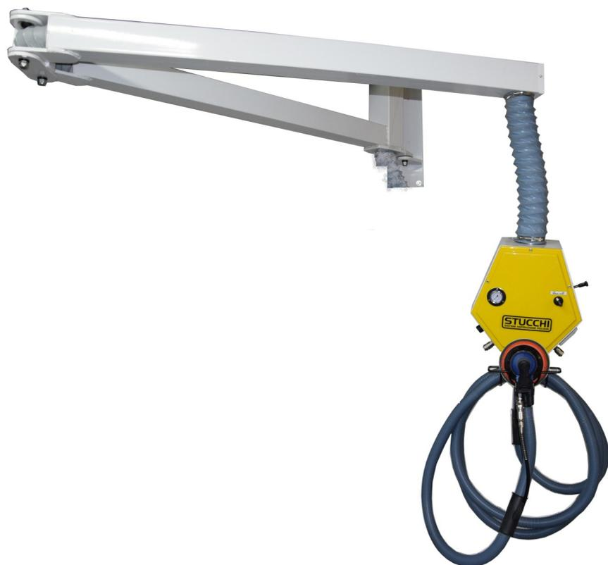
Bracci articolati installati alla parete mediante una staffa di supporto permettono di raggiungere la posizione di lavoro nel raggio di cinque, sei o sette metri con una rotazione di 180°, eliminando l'ingombro di cavi elettrici, tubi per l'aria compressa e tubi d'aspirazione
