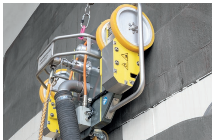
Spiderjet M – Dispositivo de limpieza de superficies con adhesión magnética
