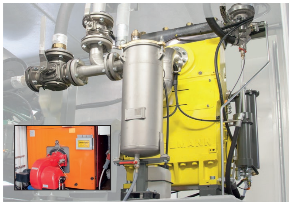
Una unidad de calentamiento de agua independiente suministra agua caliente a presión. La alta presión es generada por la bomba de alta presión.
