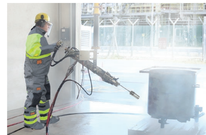
Jetmate – Herramienta de alta presión sin fuerza de reacción
