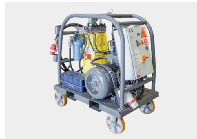
Unidades compactas con panel de control y herramientas de alta presión
