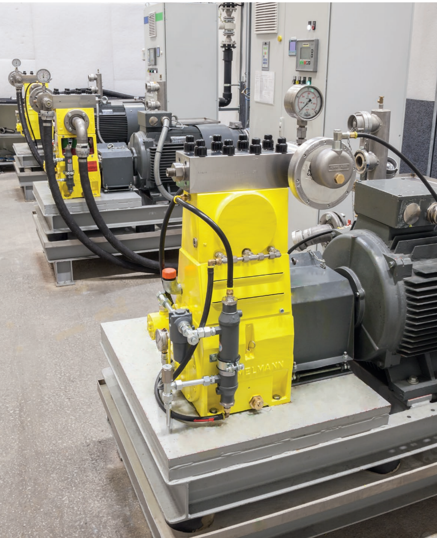
Estaciones de pruebas para todos los modelos de bombas. Recopilación y documentación de la información relevante del funcionamiento.
