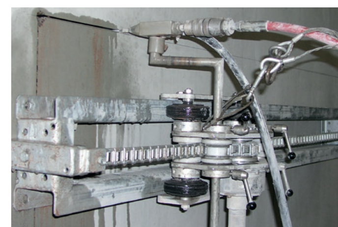
Inyectores móviles de corte abrasivo y equipos de manipulación
