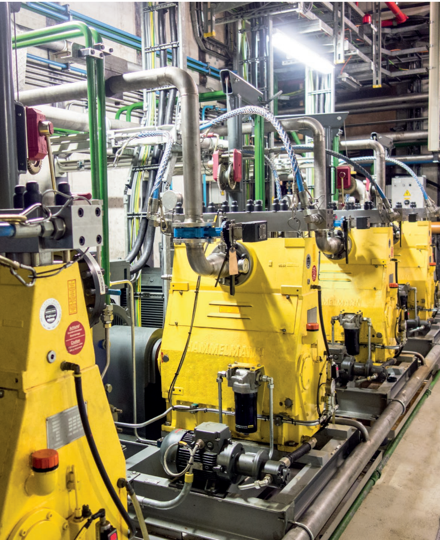
Bombas de alta presión en la industria del aluminio. Operativas desde 2009 con un promedio de 5000 horas de trabajo por año.
