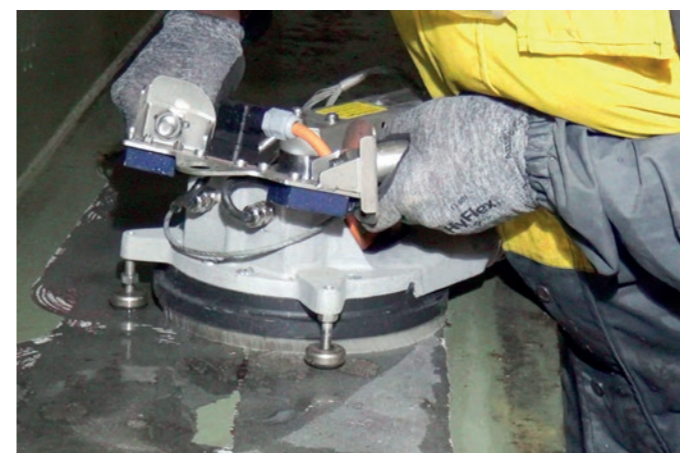
Handheld Aquablast – Equipo de limpieza manual de superficies
