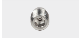
TIPO: H CHORRO RECTO Presión: hasta 2500 bar Factor de efectividad: 0.75 Material: Acero/zafiro Boquilla: 0.25 – 1.0 mm
