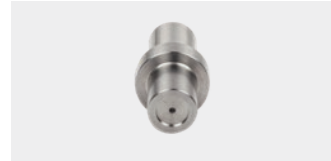
TIPO: A CHORRO RECTO Presión: hasta 2000 bar Factor de efectividad: 0.95 Material: Acero Boquilla: 0.4 – 4.9 mm
