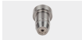
TIPO: L CHORRO RECTO Presión: hasta 1200 bar Factor de efectividad: 0.95 Material: Acero Boquilla: 1.0 – 3.9 mm
