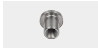
TIPO: K CHORRO RECTO Presión: hasta 2500 bar Factor de efectividad: 0.75 Material: Acero/zafiro Boquilla: 0.3 – 1.0 mm
