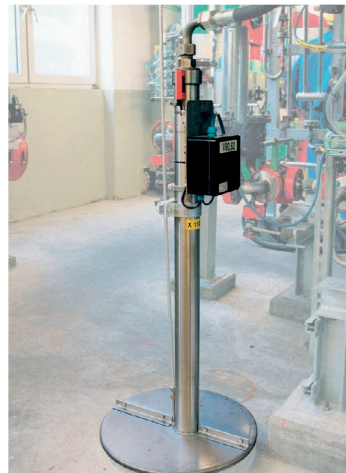
Sistema de lanza con movimiento hidráulico y accionamiento neumático
