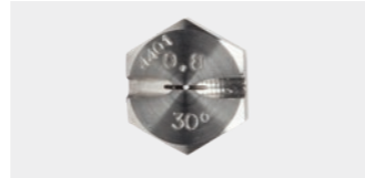
TIPO: D CHORRO ABANICO Presión: hasta 400 bar Factor de efectividad: 0.67 Material: Acero Boquilla: 0.4 – 4.6 mm
