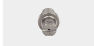
TIPO: B CHORRO ABANICO Presión: hasta 2000 bar Factor de efectividad: 0.67 Material: Acero Boquilla: 0.8 – 3.0 mm
