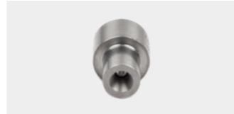
TIPO: I CHORRO RECTO Presión: hasta 3000 bar Factor de efectividad: 0.7 Material: Acero/zafiro Boquilla: 0.4 – 1.1 mm
