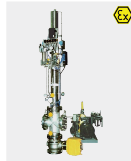
Sistema presurizado de lanza Lanza telescópica de cuatro tramos accionada por agua a alta presión. El sistema de limpieza es controlado y monitorizado por un PLC programable.
