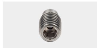
TIPO: P CHORRO RECTO Presión: hasta 3000 bar Factor de efectividad: 0.71 Material: Acero/zafiro Boquilla: 0.15 – 1.5 mm
