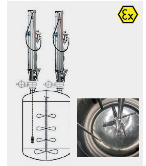
Sistema de doble lanza El sistema completo de limpieza es accionado mediante el agua a alta presión y aire comprimido libre de aceites. La transmisión mediante cadena como alternativa para recorridos de 4.5 m o más.
