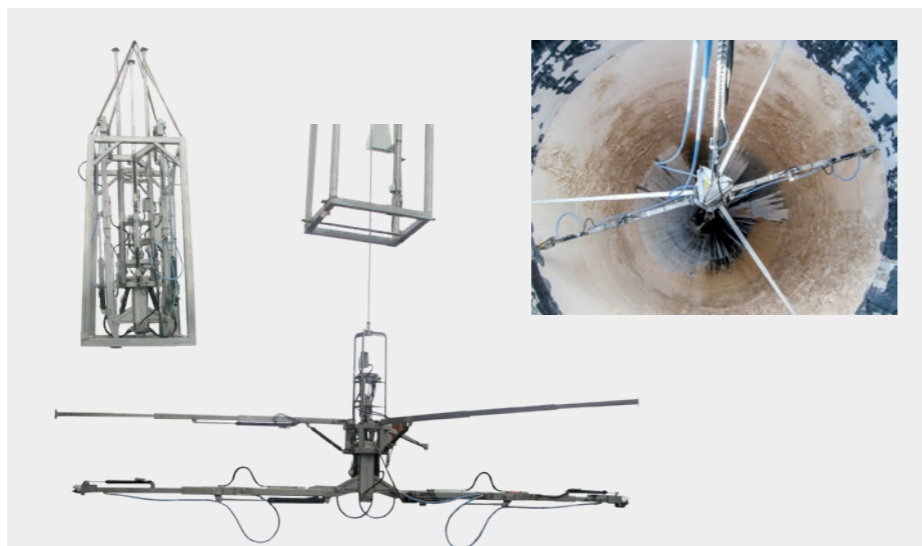
Sistema de limpieza para tanques de grandes dimensiones Sistema diseñado para la limpieza de tanques de grandes dimensiones de hasta 20 m de diámetro. Se introduce en el tanque y se fija con tres brazos extensibles. Los cabezales de limpieza se posicionan en la superficie a limpiar con un brazo telescópico de manera hidráulica. Se extienden o retraen hidráulicamente y giran verticalmente accionadas por cilindros hidráulicos.
