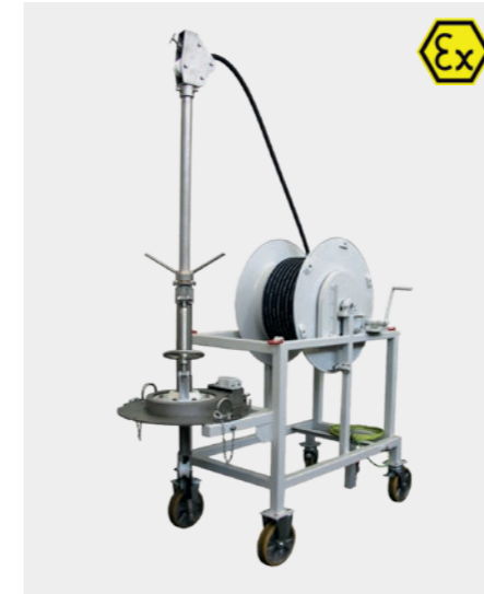
Sistema de lanza con enrollador La lanza puede rotar, girar y extenderse. Se une a una boca de inspección. El dispositivo de limpieza sube o baja con una manivela.
