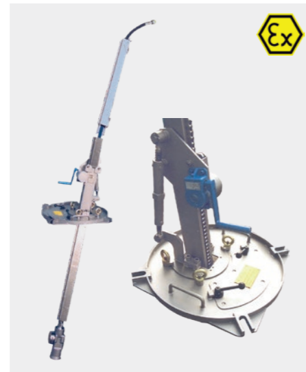
Sistema manual de lanza Sistema extensible manual, que ajusta la distancia de la boquilla a través de una manivela y una cadena.
