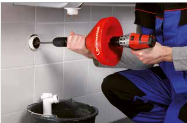
Funcionamiento eléctrico con taladro a batería
