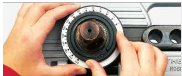
Ajuste previo del ángulo de la curva sin herramientas
