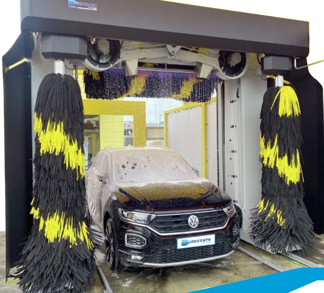
El modelo Air Plus ofrece un válido sistema alternativo dispositivo de techo controlado mediante boquillas de alta presión y ventiladores para el aire en la parte superior de la instalación que realizan una rotación de los sistemas de suministro de agua y aire.
