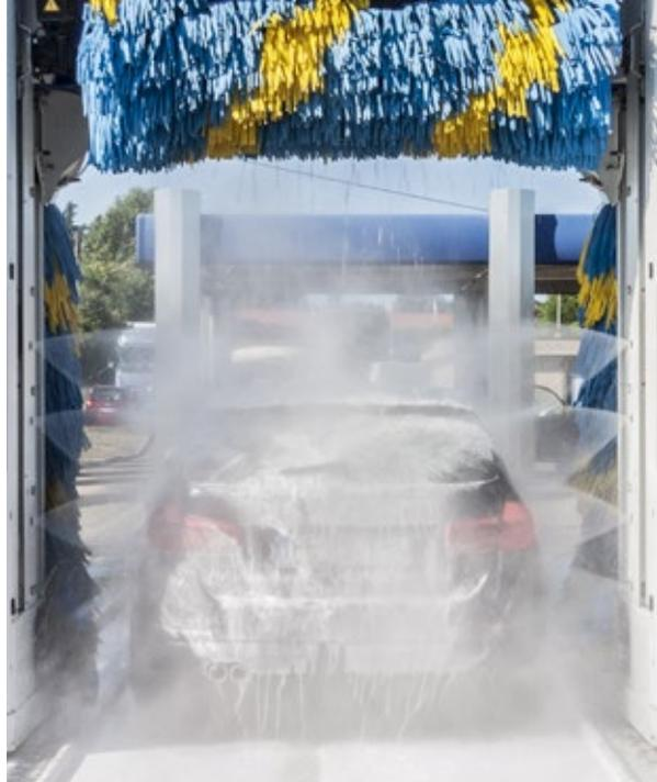
Este sistema de alta presión también está montado en la boca horizontal del secado. Realizado con boquillas fijas sigue el perfil de los coches inclinándose a más posiciones para mantener una perpendicularidad con la carrocería obteniendo un efecto mayor. Completa el grupo la alta presión lateral fija.
