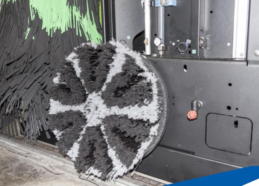
Wheel Master es el sistema dedicado a lavar las ruedas, los costados y todas las partes bajas de los coches. Dotado de tres boquillas a alta presión (una dedicada a las partes altas) en un equilibrio ideal de potencia y delicadeza, Wheel Master realiza una óptima intervención incluso en las zonas difíciles. Completamente en acero inoxidable, admite diferentes combinaciones de uso: solo suministro de detergente, solo alta presión, solo cepillado o combinados.
