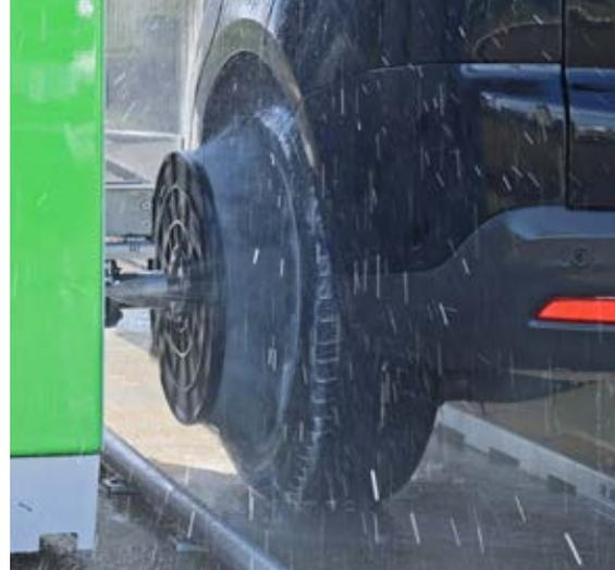
Wheel Master es el sistema dedicado a lavar las ruedas, los costados y todas las partes bajas de los coches. Dotado de tres boquillas a alta presión (una dedicada a las partes altas) en un equilibrio ideal de potencia y delicadez, Wheel Master realiza una óptima intervención incluso en las zonas difíciles. Completamente en acero inoxidable, admite diferentes combinaciones de uso: solo suministro de detergente, solo alta presión, solo cepillado o combinados.
