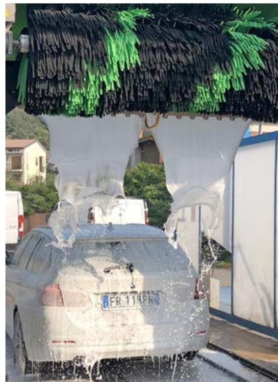
Dos modelos de cortina de espuma disponibles, en lluvia y en caída. Una cascada de espuma iluminada con LED, crea un efecto cromático sobre el coche cubriéndolo con una espuma densa capaz de favorecer la acción de los cepillos y/o de interactuar con el producto emoliente para una limpieza más profunda y además muy escenográfica.
