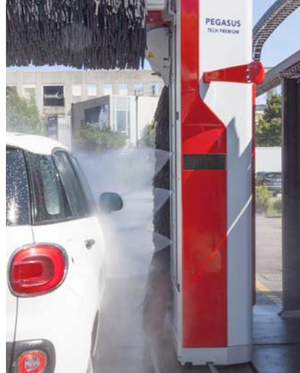
Este sistema de alta presión también está montado en la boca horizontal del secado. Realizado con boquillas fijas sigue el perfil de los coches inclinándose a más posiciones para mantener una perpendicularidad con la carrocería obteniendo un efecto mayor. Completa el grupo la alta presión lateral fija.
